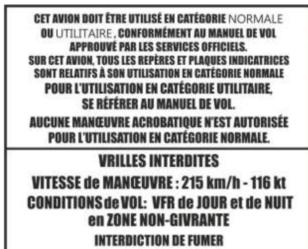
Figure 2-21 - Sur le plafond de la verrière mobile
