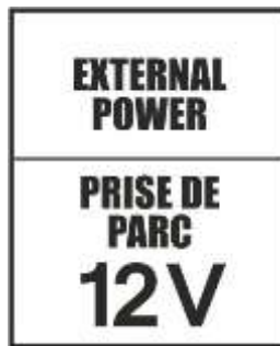
Figure 2-6 - Le cas échéant, sur la trappe d'accès à la prise de parc derrière l'aile sur la partie droite de l'avion.
